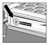
■ Нажмите на индикатор замены фильтра выходящего воздуха timestrip.
